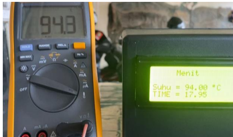
Gambar 4. Pengujian Thermocouple Dan Max6675
